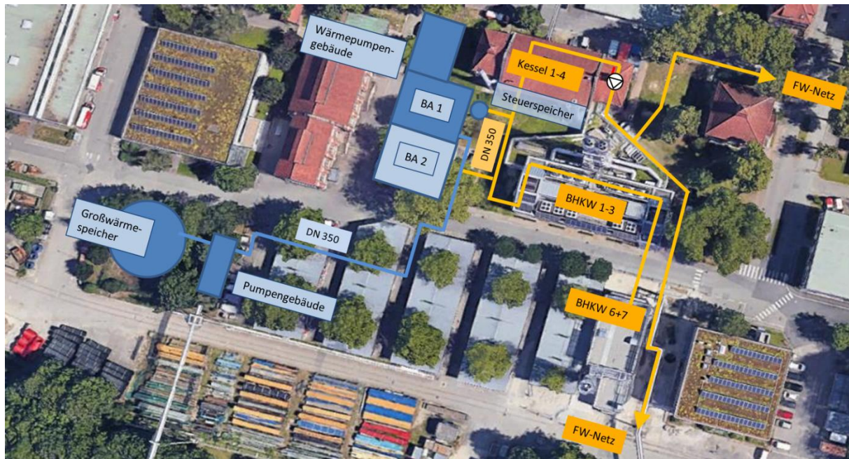
Abbildung 5: Geografische Lage der Fernwärmeerzeugungseinheiten am Standort Hauffstraße
